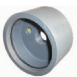
**ГОЛОВКИ ДЛЯ ЗАКРЫТИЯ КОЛОДЦА ИЗ ПВХ** нажимного типа, с центральным отверстием, пробкой и отверстием для прохода кабелей. По сравнению с нормальными головками для закрытия колодца они стоят меньше и устанавливаются быстрее, поскольку не имеют винтов и болтов; изоляция колодца от внешней среды обеспечивается резиновой прокладкой (уплотнительным кольцом), позиционированной во внутренней части.
