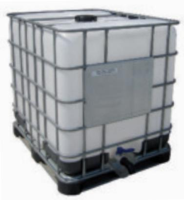
**МАЛЪК РЕЗЕРВОАР ОТ HDPE** за транспортиране на течности, с външна метална конструкция, снабден с входен отвор Ø 135 mm, затворен от капак с уплътнение от горната страна и изходен отвор Ø 50 mm с кран в долната част. Вместимост 1000 л, размери: височина 116,30 см, основа 120 x 100 см.
