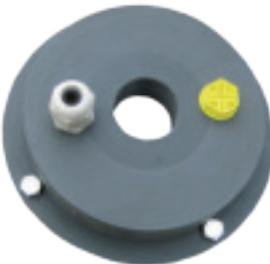
**ПВЦ ГЛАВИ ЗА ЗАТВАРЯНЕ НА КЛАДЕНЕЦ** с централен отвор, тапа и кабелен щуцер. Главите са съставени от фланец и контрафланец и се свързват и затягат с винтове и болтове. Използват се за подсигуряване на защитата на кладенеца от възможни замърсявания.
