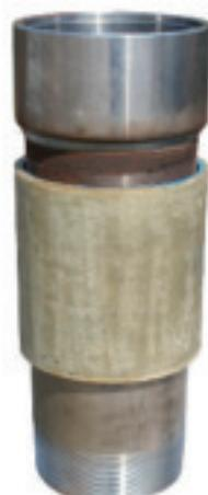
**ДИЕЛЕКТРИЧЕСКА ВРЪЗКА** От голяма значимост за осигуряване на постоянната електроизолация между единния материал и другия, когато колоната е съставена от тръби от различни материали (например неръждаема стомана и въглеродна стомана), освен това диелектричната връзка предпазва частта от колоната надолу от евентуални блуждащи токове.
