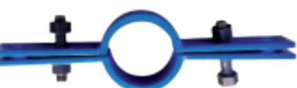
**СТОМАНЕН ФИКСАТОР-СКОБА** за поддържане на колоната по време на спускане, който се поставя на мин. 300 mm дистанция от присъединителната част на тръбата, за да се предотвратят деформации на резбата.
