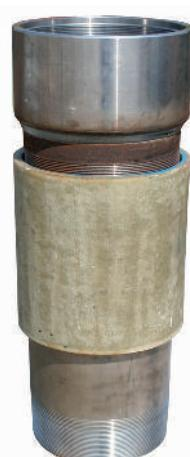
**ДИЕЛЕКТРИЧЕСКА ВРЪЗКА** От голяма значимост за осигуряване на постоянната електроизолация между единния материал и другия, когато колоната е съставена от тръби от различни материали (например неръждаема стомана и въглеродна стомана), освен това диелектричната връзка предпазва частта от колоната надолу от евентуални блуждащи токове.
