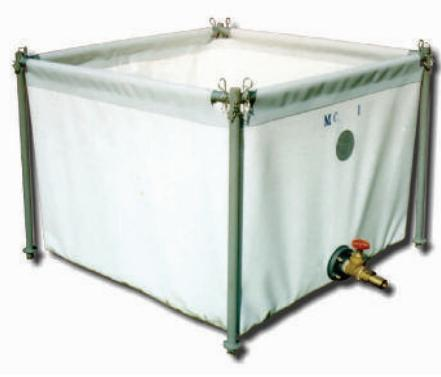
**ГЪВКАВ РЕЗЕРВОАР ЗА ТЕЧНОСТИ**, съставен от изключително устойчив полиестерен сак, покрит с пластомери, поддържан от лесно сглобяема метална рамка. Вместимост от 1 m<sup>3</sup> до 60 m<sup>3</sup> (в зависимост от размерите, вж таблицата по-долу). Когато не се използва, резервоарът може да се сгъва и да намали габаритите си до минимум.
