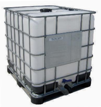
**МАЛЪК РЕЗЕРВОАР ОТ HDPE** за транспортиране на течности, с външна метална конструкция, снабден с входен отвор Ø 135 mm, затворен от капак с уплътнение от горната страна и изходен отвор Ø 50 mm с кран в долната част. Вместимост 1000 л, размери: височина 116,30 см, основа 120 x 100 см.
