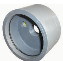
**ГОЛОВКИ ДЛЯ ЗАКРЫТИЯ КОЛОДЦА ИЗ ПВХ** нажимного типа, с центральным отверстием, пробкой и отверстием для прохода кабелей. По сравнению с нормальными головками для закрытия колодца они стоят меньше и устанавливаются быстрее, поскольку не имеют винтов и болтов; изоляция колодца от внешней среды обеспечивается резиновой прокладкой (уплотнительным кольцом), позиционированной во внутренней части.
