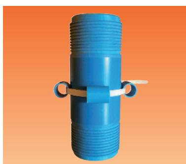
**ПЛАСТМАСОВО ЦЕНТРИРАЩО УСТРОЙСТВО**, което поддържа колоната от тръби в централно положение по време на спускане. Състои се от отделни части, които се склучват лесно помежду си: една фиксираща скоба и 3 бр. малки тръбни парчета с различни диаметри в зависимост от конкретната необходимост, разположени на еднакви разстояния помежду си. Ефикасно и евтино решение.
