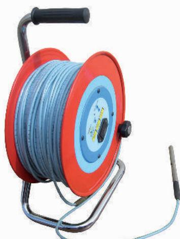
**ПРЕНОСИМА СОНДА ЗА НИВО** за измерване на подпочвената вода в кладенци, пиезометри и др. Инструментът е съставен от кръгъл кабел с отбелязани сантиметри, който се предлага в различни дължини от 50 до 500 m, с корпус на сондата от неръждаема стомана 304 Ø 12 mm и макара за увиване на кабела, дръжка за транспортиране и електронна платка с устройство за звуков и светлинен предупредителен сигнал и предупредителен светодиод за изтощена батерия.
